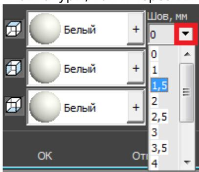
В случае, если на разных стенах помещения нужен разный размер шва, это можно указать в процессе укладки плитки. Однако значение размера шва по умолчанию для текущего проекта указывается именно на этапе создания короба помещения.
