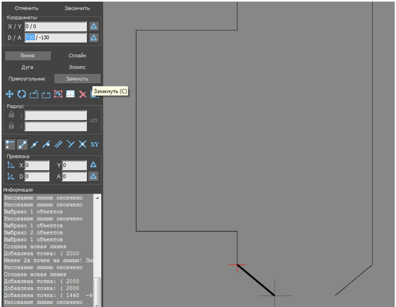
После построения можно выделить мышью контур, проверяя опорные точки построения:
