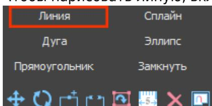
Кликните левой кнопкой мыши по рабочему полю – вы отметили первую точку, - кликните второй раз, и линия будет построена. Чтобы продолжить построение из текущей точки, кликните мышкой в ещё одной части поля. Однако, чтобы чётреж получился не примерным, а точным следует использовать [точное введение координат](#) и [привязки](#).
