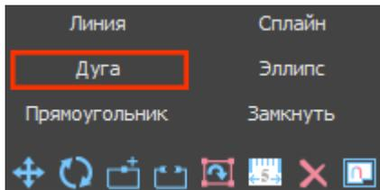
Кликните левой кнопкой мыши по рабочему полю – вы отметили первую точку, - кликните второй раз. Поводите мышкой, регулируя положение и размер дуги до нужного вам. По третьему клику мыши вы отрегулируете положение дуги и её построение будет завершено.
