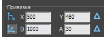
**Например**, нужно построить помещение, у которого длина стен кратна 1000 мм, и эти стены располагаются под углами, кратным 15 градусам.
