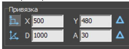
Например, нужно построить помещение, у которого длина стен кратна 1000 мм. Для этого, включите **Привязку к прямоугольной сетке** нажатием на соответствующую пиктограмму (рис. см выше) и введите в поле **X** – 1000 и в поле **Y** также 1000. При построении помещения с помощью примитива «линия», все отрезки будут кратны 1000 мм как по горизонтали, так и по вертикали. Т.е. не получится построить отрезок по оси X или Y, например, длиной 750 мм – только 1000, 2000, 3000 и т.д.
