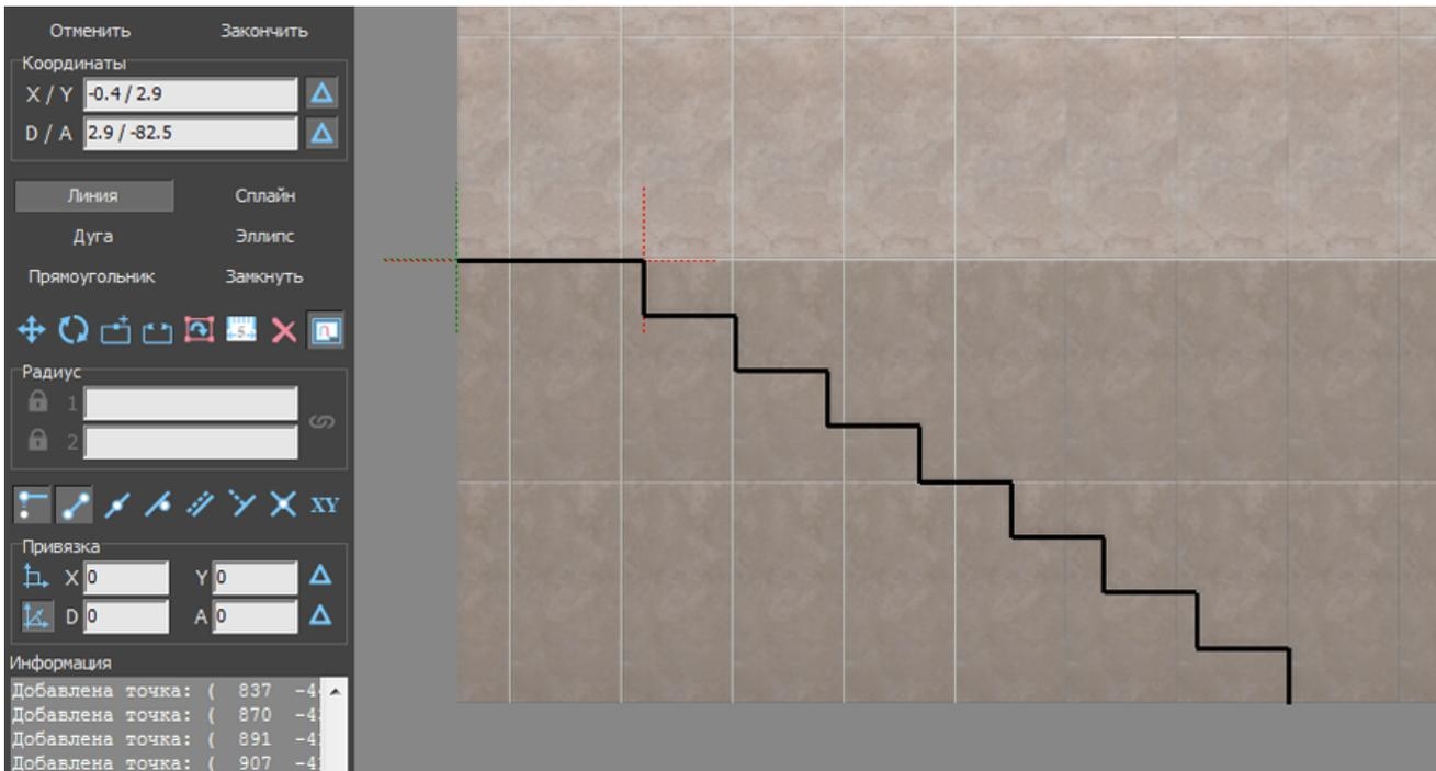
10. Когда основной контур лестницы построен, следует обрисовать также контур несущей конструкции.
