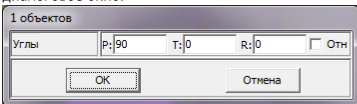
В данном диалоговом окне реализована возможность как поворота относительно текущего положения объекта (который уже может быть размещён под некоторым углом), так и указания абсолютного значения.
